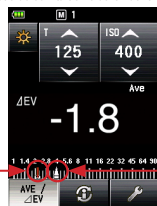
Ejemplo de pantalla (medición de acuerdo con la fuente de luz de relleno)
